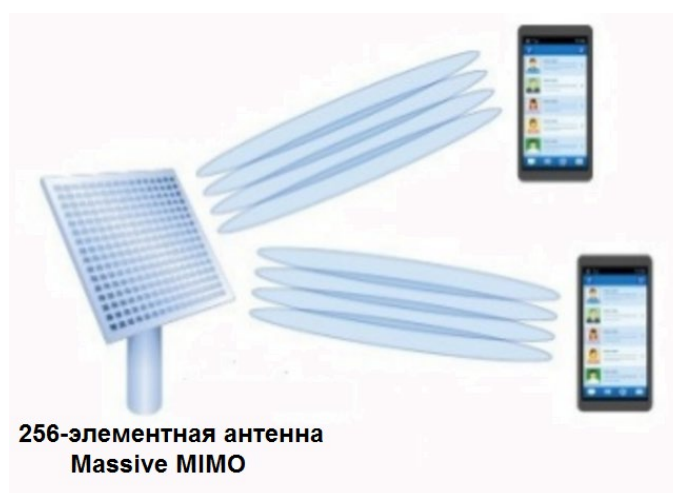
2.3 Сурет – Massive MIMO-ның жүзеге асу барысы
