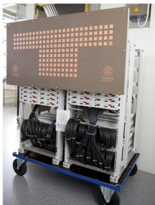
2.5 Сурет – Шведциядағы Lund университетінің USRP RIO құрылғысының негізінде (сол жағы) антеналық торларды (оң жағы) шығару
